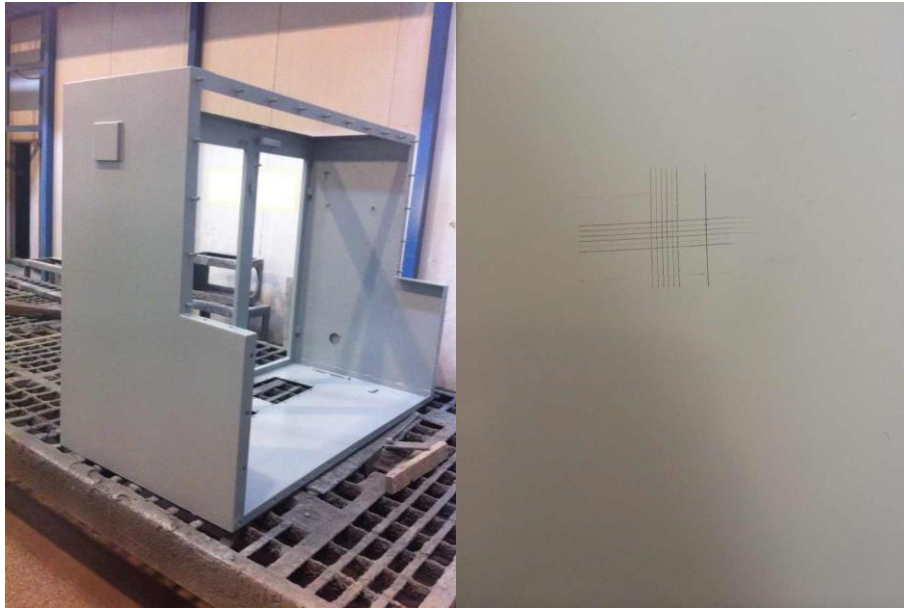
图 6 锌铝涂镀底漆喷涂 B05 氟碳面漆后的漆膜外观及附着力
